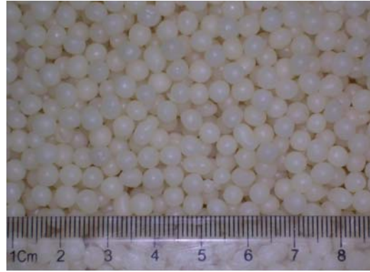
图 4. 70 # 微晶蜡球形粒蜡产品（4~5mm）
