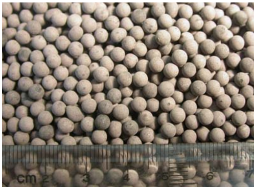
图 5. 橡胶助剂 4020 造粒样品（4±0.3 mm）
