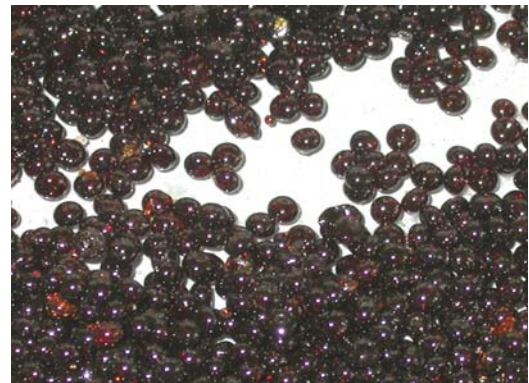
图 6. 橡胶防老化剂 RD 造粒样品（2~3mm）
